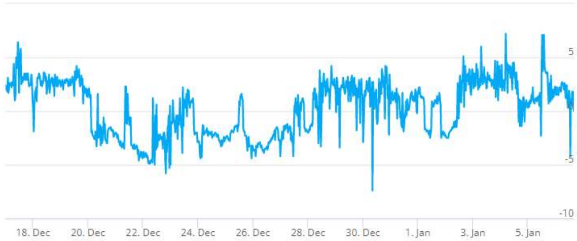
Kuva 17. Tutkimuspiste L5 (P2), 1. krs opettajien taukotila (115). Sisäilman ja ulkoilman välinen paine-ero 17.12. – 6.1.2022.
