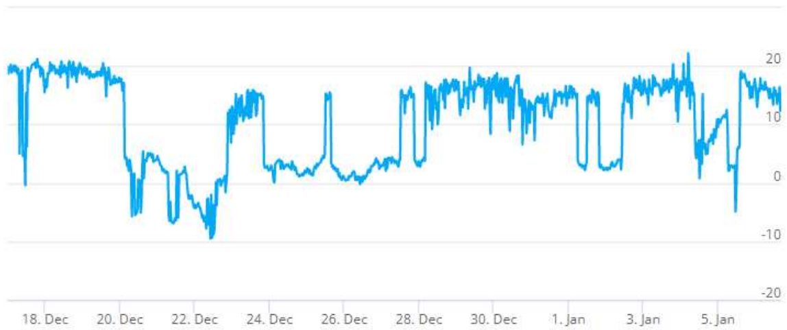
Kuva 35. Tutkimuspiste L8 (P5), kellarikerroksen ruokala 02. Sisäilman ja ulkoilman välinen paine-ero 17.12. - 6.1.2022.
