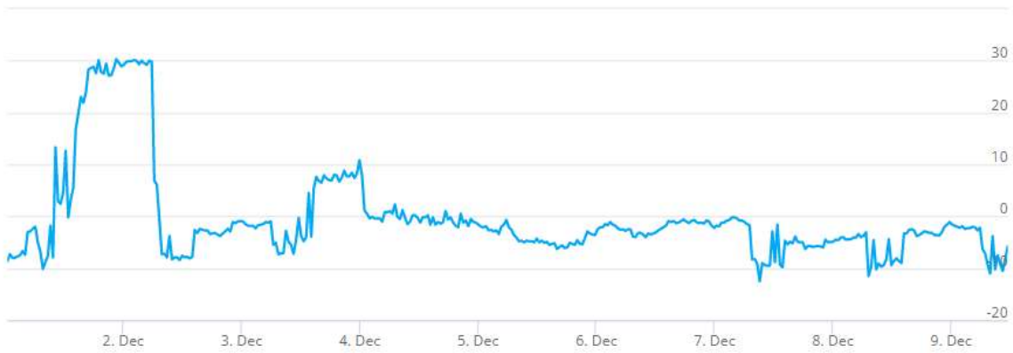
Kuva 33. Tutkimuspiste L8 (P5), kellarikerroksen ruokala 02. Sisäilman ja ulkoilman välinen paine-ero 1.12. - 9.12.2021, ka - 0,03 Pa.
