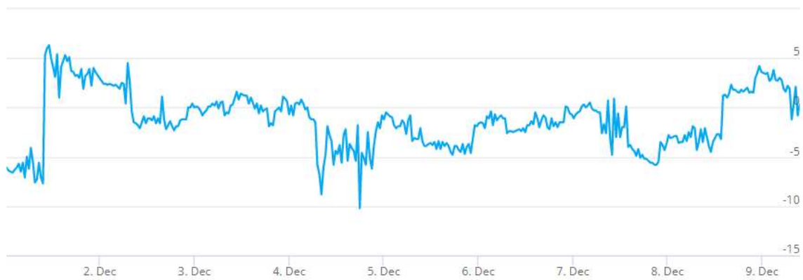
Kuva 48. Tutkimuspiste L10 (P3), kellarikerroksen puutyötila 023. Sisäilman ja ulkoilman välinen paine-ero 1.12.-9.12.2021, ka - 0,1 Pa.
