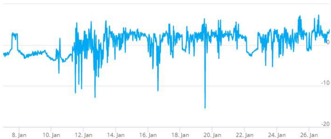
Kuva 18. Tutkimuspiste L5 (P2), 1. krs opettajien taukotila (115). Sisäilman ja ulkoilman välinen paine-ero 7.1. – 27.1.2022.
