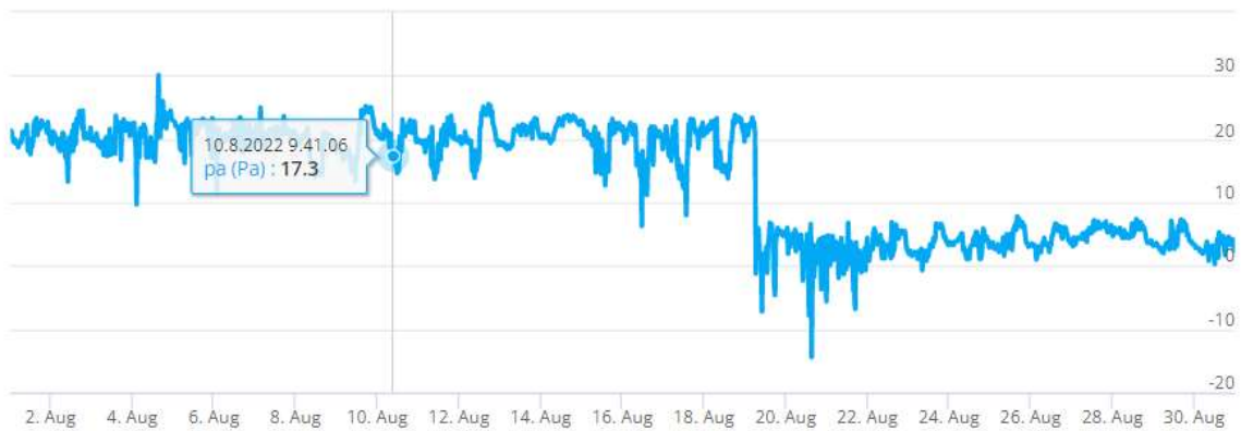
Kuva 54. Tutkimuspiste L10 (P3), kellarikerroksen puutyötila 023. Sisäilman ja ulkoilman välinen paine-ero 1.8.-31.8.2022.
