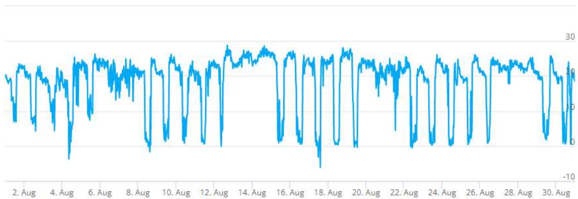
Kuva 12. Tutkimuspiste L4 (P1), 1. krs luokkatila 105 (Luokka 1). Sisäilman ja ulkoilman välinen paine-ero 1.8. – 31.8.2022.
