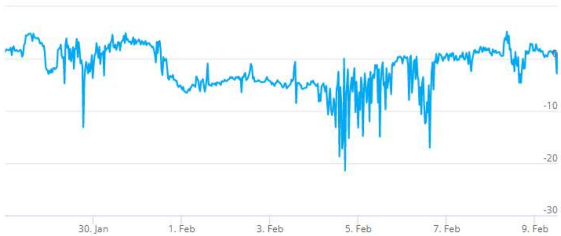
Kuva 52. Tutkimuspiste L10 (P3), kellarikerroksen puutyötila 023. Sisäilman ja ulkoilman välinen paine-ero 28.1.-9.2.2022.
