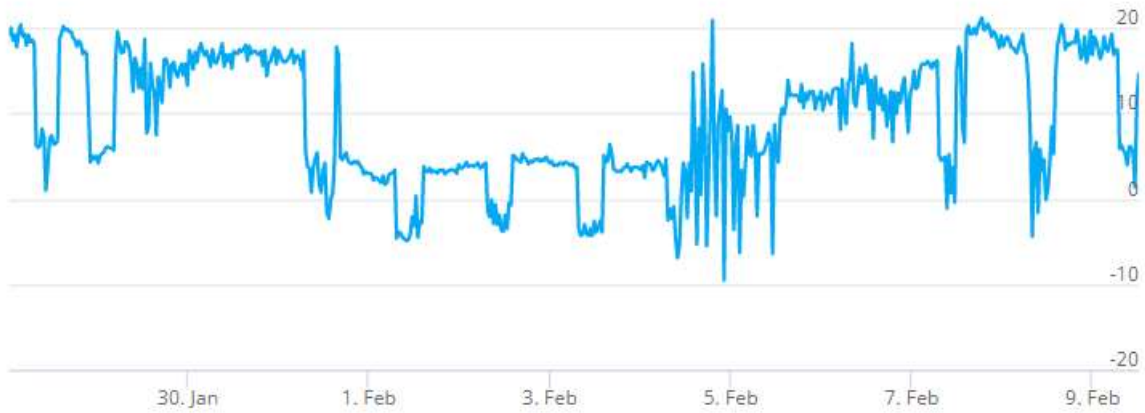
Kuva 37. Tutkimuspiste L8 (P5), kellarikerroksen ruokala 02. Sisäilman ja ulkoilman välinen paine-ero 28.1. - 9.2.2022.
