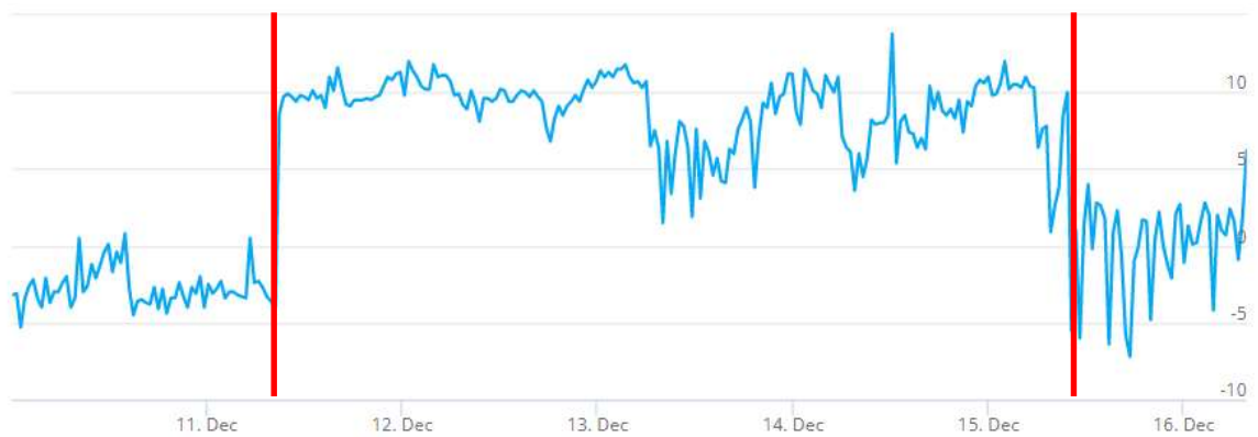
Kuva 16. Tutkimuspiste L5 (P2), 1. krs opettajien taukotila (115). Sisäilman ja ulkoilman välinen paine-ero 10.12. – 16.12.2021.
