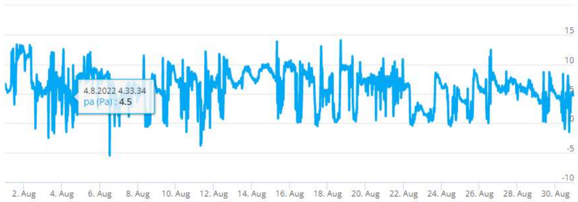
Kuva 21. Tutkimuspiste L5 (P2), 1. krs opettajien taukotila (115). Sisäilman ja ulkoilman välinen paine-ero 1.8. – 31.8.2022.
