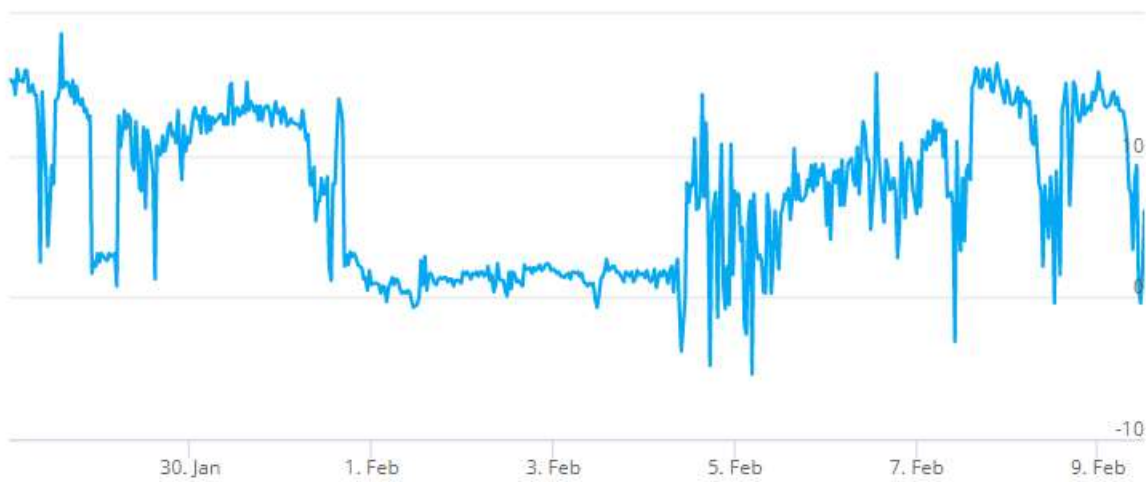
Kuva 10. Tutkimuspiste L4 (P1), 1. krs luokkatila 105 (Luokka 1). Sisäilman ja ulkoilman välinen paine-ero 28.1. – 9.2.2022.
