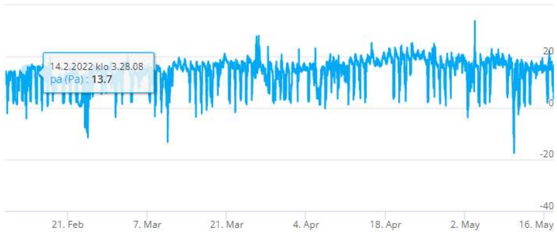
Kuva 11. Tutkimuspiste L4 (P1), 1. krs luokkatila 105 (Luokka 1). Sisäilman ja ulkoilman välinen paine-ero 10.2. – 17.5.2022.
