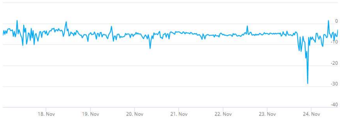
Kuva 13. Tutkimuspiste L5 (P2), 1. krs opettajien taukotila (115). Sisäilman ja ulkoilman välinen paine-ero 17.11. – 24.11.2021, ka – 5,4 Pa.
