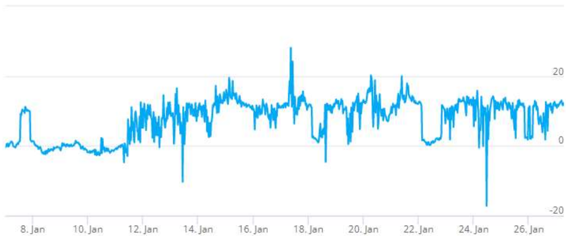
Kuva 28. Tutkimuspiste L7 (P4), 1. krs luokkatila 104 (Luokka 2.). Sisäilman ja ulkoilman välinen paine-ero 7.1.-27.1.2022.
