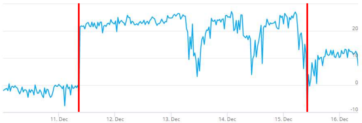
Kuva 26. Tutkimuspiste L7 (P4), 1. krs luokkatila 104 (Luokka 2.). Sisäilman ja ulkoilman välinen paine-ero 10.12.-16.12.2021.
