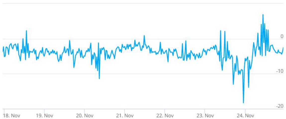
Kuva 24. Tutkimuspiste L7 (P4), 1. krs luokkatila 104 (Luokka 2.). Sisäilman ja ulkoilman välinen paine-ero 17.11.-24.11.2021, ka -4,1 Pa.
