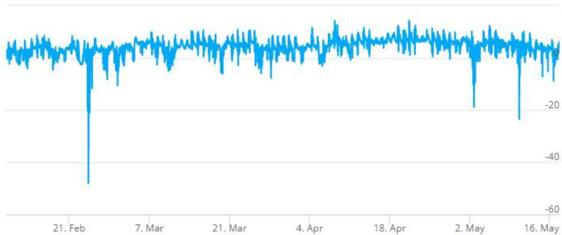
Kuva 20. Tutkimuspiste L5 (P2), 1. krs opettajien taukotila (115). Sisäilman ja ulkoilman välinen paine-ero 10.2. – 17.5.2022.
