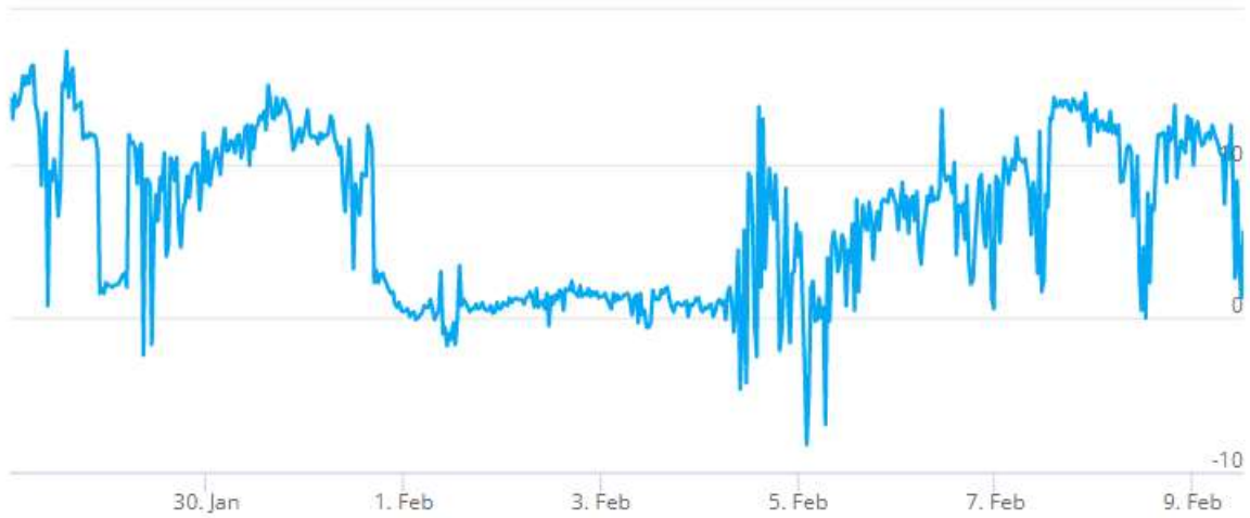
Kuva 29. Tutkimuspiste L7 (P4), 1. krs luokkatila 104 (Luokka 2.). Sisäilman ja ulkoilman välinen paine-ero 28.1.-9.2.2022.
