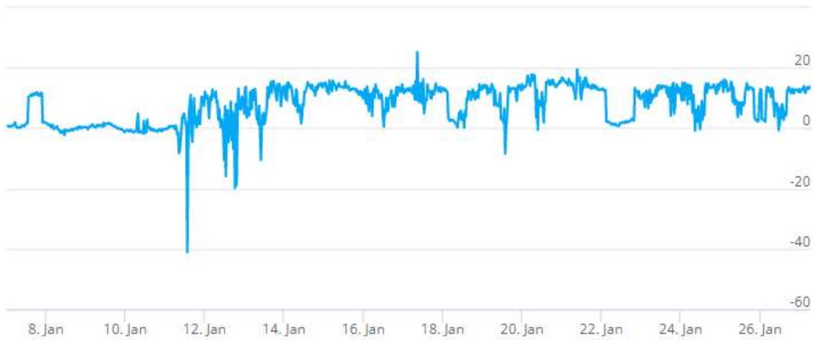
Kuva 9. Tutkimuspiste L4 (P1), 1. krs luokkatila 105 (Luokka 1). Sisäilman ja ulkoilman välinen paine-ero 7.1. – 27.1.2022.
