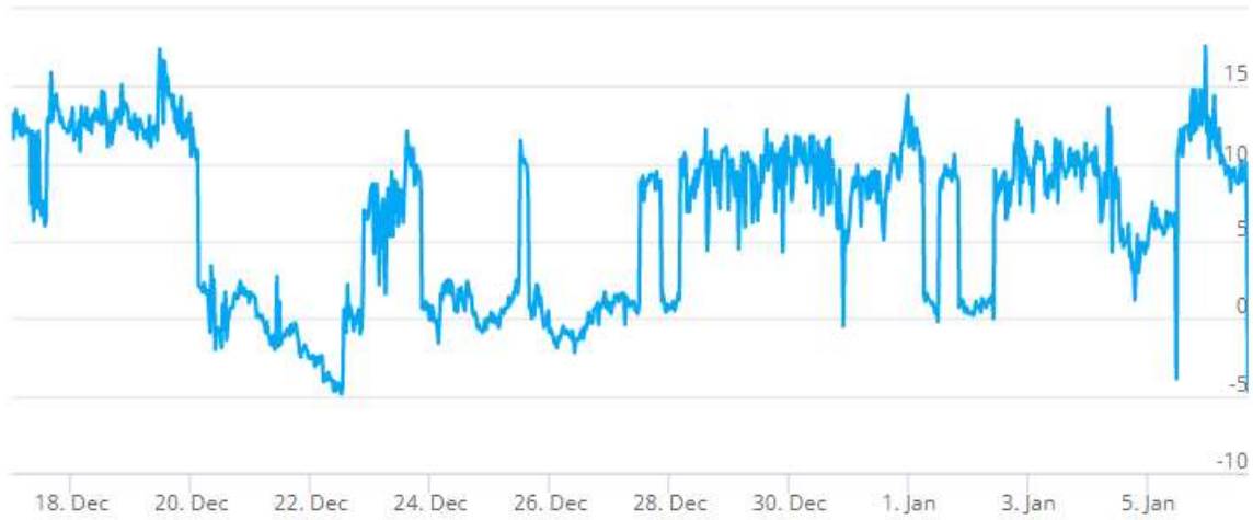
Kuva 27. Tutkimuspiste L7 (P4), 1. krs luokkatila 104 (Luokka 2.). Sisäilman ja ulkoilman välinen paine-ero 17.12.-6.1.2022.
