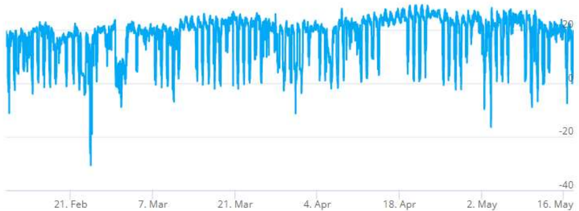
Kuva 38. Tutkimuspiste L8 (P5), kellarikerroksen ruokala 02. Sisäilman ja ulkoilman välinen paine-ero 10.2. - 17.5.2022.
