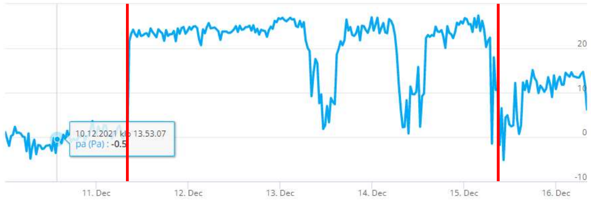
Kuva 7. Tutkimuspiste L4 (P1), 1. krs luokkatila 105 (Luokka 1). Sisäilman ja ulkoilman välinen paine-ero 10.12. – 16.12.2021.
