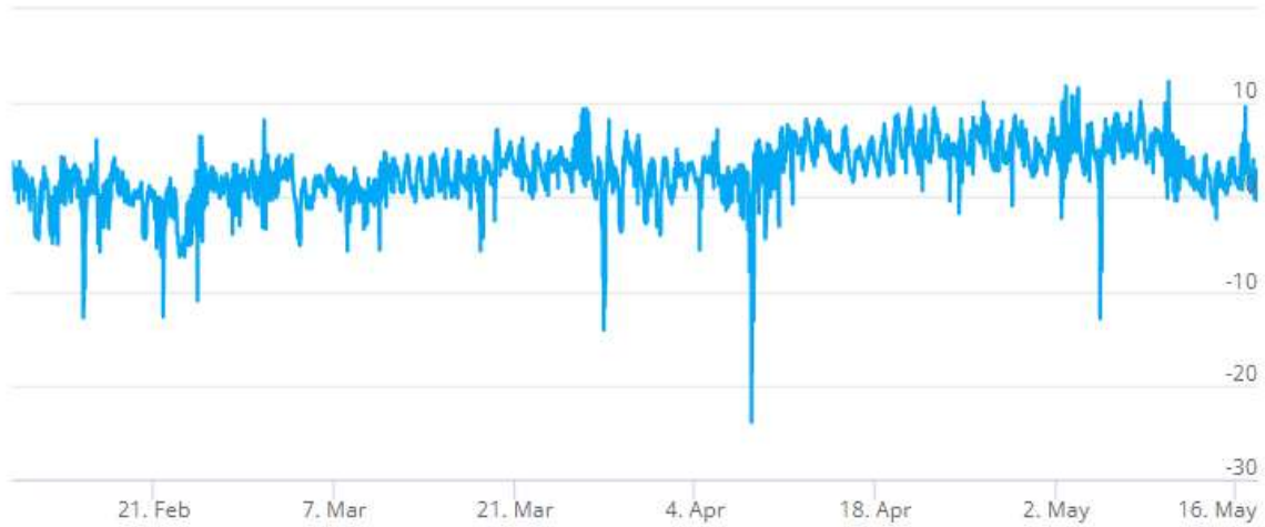
Kuva 53. Tutkimuspiste L10 (P3), kellarikerroksen puutyötila 023. Sisäilman ja ulkoilman välinen paine-ero 10.2.-17.5.2022.
