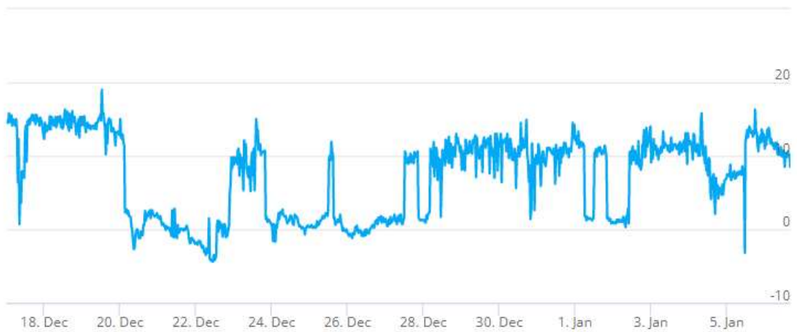
Kuva 8. Tutkimuspiste L4 (P1), 1. krs luokkatila 105 (Luokka 1). Sisäilman ja ulkoilman välinen paine-ero 17.12. – 6.1.2022.
