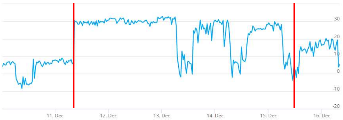
Kuva 34. Tutkimuspiste L8 (P5), kellarikerroksen ruokala 02. Sisäilman ja ulkoilman välinen paine-ero 10.12. - 16.12.2021.
