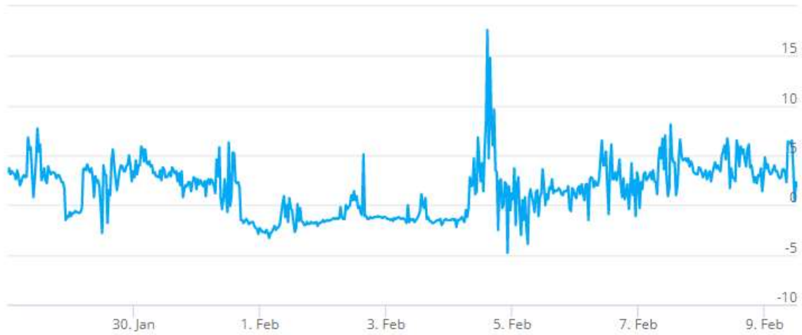
Kuva 19. Tutkimuspiste L5 (P2), 1. krs opettajien taukotila (115). Sisäilman ja ulkoilman välinen paine-ero 28.1. – 9.2.2022.
