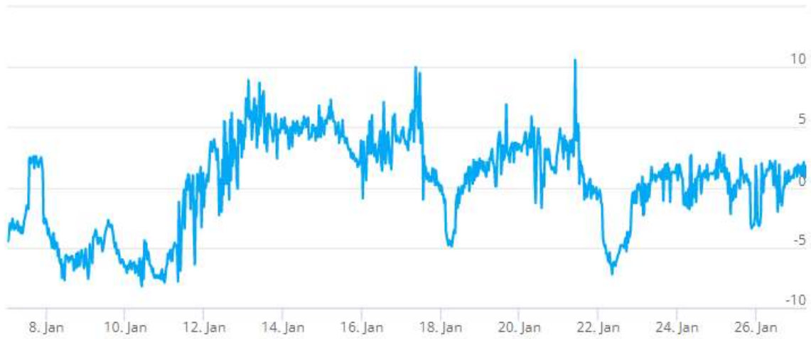
Kuva 51. Tutkimuspiste L10 (P3), kellarikerroksen puutyötila 023. Sisäilman ja ulkoilman välinen paine-ero 7.1.-27.1.2022.
