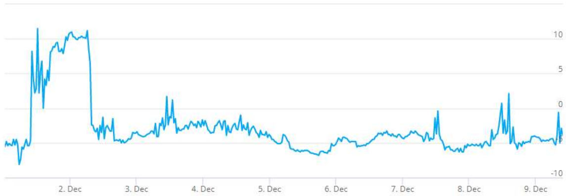
Kuva 15. Tutkimuspiste L5 (P2), 1. krs opettajien taukotila (115). Sisäilman ja ulkoilman välinen paine-ero 1.12. – 9.12.2021, ka – 2,7 Pa.
