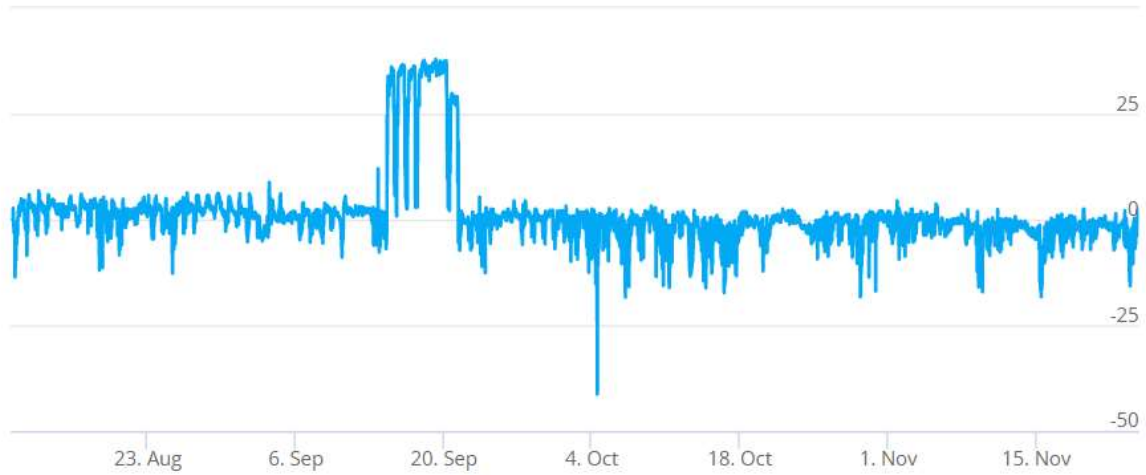
Kuva 5. Tutkimuspiste L4 (P1), 1. krs luokkatila 105 (Luokka 1). Sisäilman ja ulkoilman välinen paine-ero 10.8. – 25.11.2021, ka 1,2 Pa.
